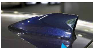
みちびき対応アンテナ
