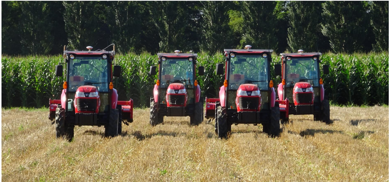
<マルチロボットシステム> 複数台の農機が自動運転による隊列走行で農作業を実施。
